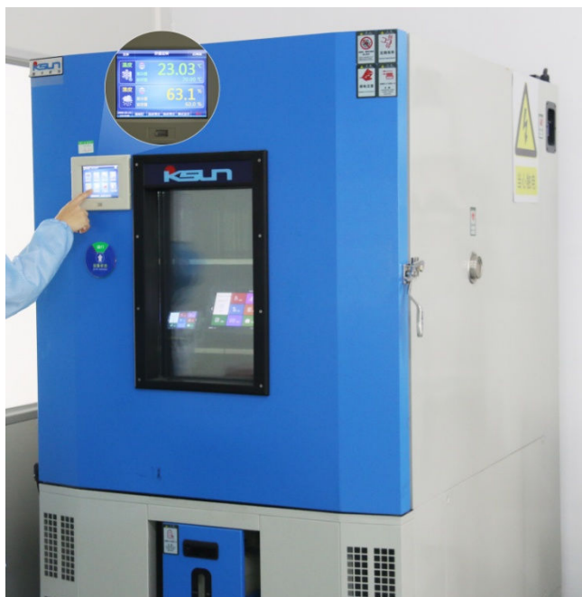
图 3-3 高低温老化测试图
